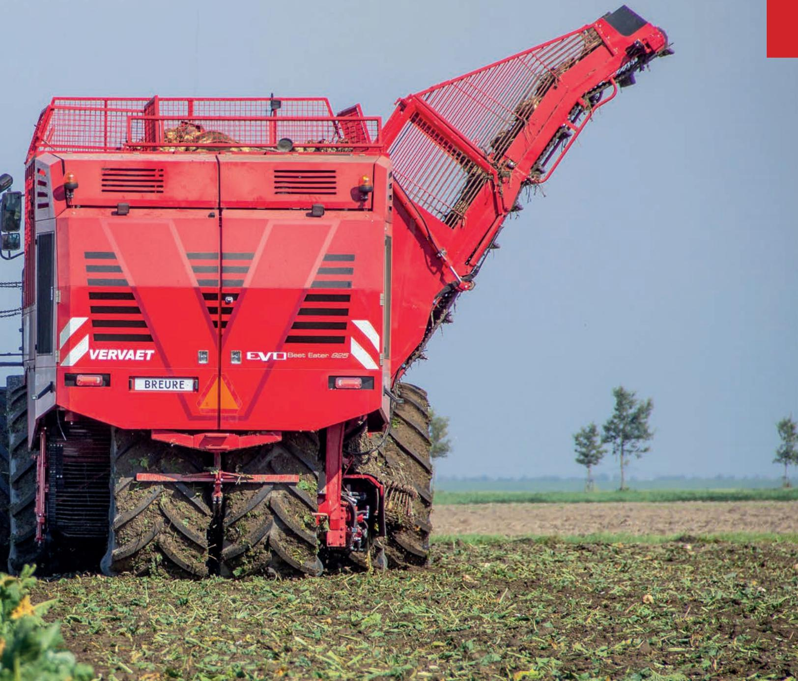
Zeker bij de 9-rijige is dit principe een unicum. Vooral omdat hier de banden slechts één maal in een spoor rijden. In combinatie met de goede gewichtsverdeling is het een capaciteitsmonster dat rekening houdt met de bodemstructuur.
