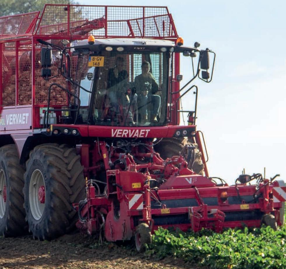
Net als de kleinere Q-series (optie), is de Beet Eater EVO uitgerust met een volautomatische vlakstelling van de machine. Deze unieke techniek houdt de bovenbouw van de rooier automatisch vlak als de omstandigheden daarom vragen. Denk aan heuvelachtige omstandigheden, maar aan ook (aflopende) slootkanten. De vlakstelling geeft extra stabiliteit en een beter verdeelde bodemdruk.
